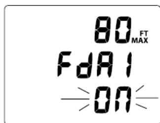
Рис. 101 Установка сигнала глубины 1 (FDA 1)
