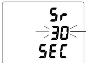
Рис. 36 Установка дискретности
