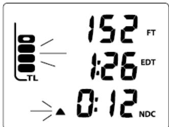
Рис. 110 Сигнал накопления тканями азота
