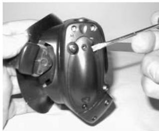
Рис. 115 Снятие крышки батарейки
