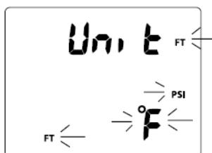
Рис. 33а Установка единиц измерения (имperialные)
