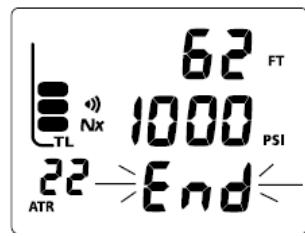
Рис. 66В Заканчивается воздух в баллоне
