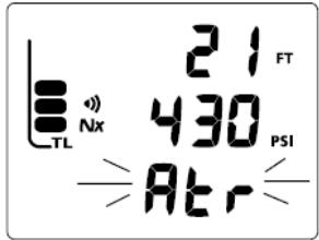
Рис. 59 Сигнал оставшегося воздушного времени (в других условиях)
