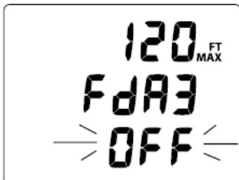
Рис. 103 Установка сигнала глубины 3 (FDA 3)
