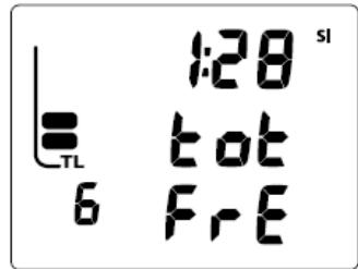
Рис. 95 Поверхностный свободный основной дисплей
