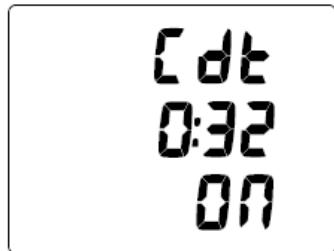
Рис. 98А Включенный таймер (осталось 32 сек)
