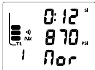
Рис. 15б Основной поверхностный нормальный (12 мин после первого погружения)
