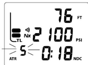
Рис. 58 Сигнал оставшегося воздушного времени (без декомпрессии)
