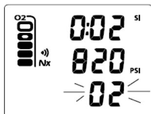
Рис. 88А Высокое парциальное давление кислорода на поверхности (более 5 минут)
