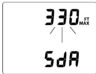
Рис. 24 Установка сигнала глубины
