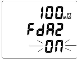
Рис. 102 Установка сигнала глубины 2 (FDA 2)
