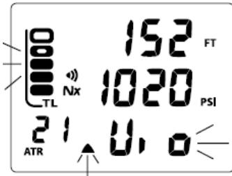
Рис. 85 Основной дисплей режима измерителя при нарушениях
