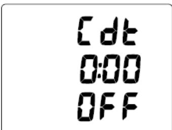
Рис. 98В Выключенный таймер (время не установлено)
