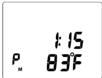
Рис. 94 Альтернативный дисплей 2 подводного измерительного режима
