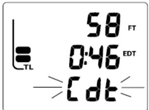
Рис. 108 Сигнал таймера свободного погружения
