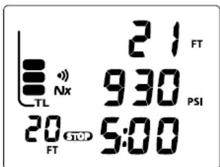
Рис. 72 Основной дисплей остановки безопасности в бездекомпрессионном режиме
