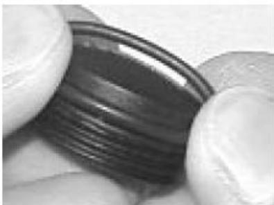
Рис. 119 Установка кольца трансмиттера
