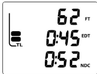
Рис. 104 Основной дисплей свободного погружения
