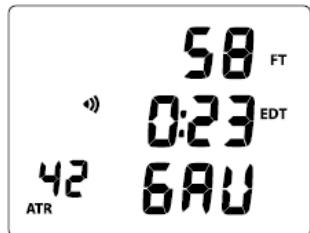
Рис. 92 Основной дисплей в подводном режиме измерителя
