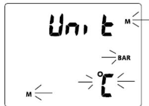
Рис. 33б Установка единиц измерения (метрические)
