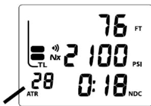
ATR отражается в цифровом значении на дисплее внизу слева (Рис. 62).
