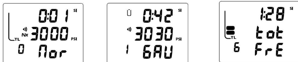
Рис. 1 Рабочие режимы нормальный, измерительный и свободных погружений
