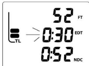
Рис. 107 Сигнал прошедшего времени свободного погружения
