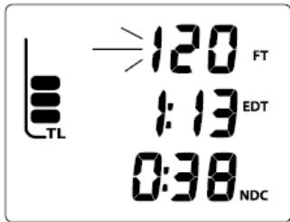
Рис. 109 Сигнал глубины свободного погружения
