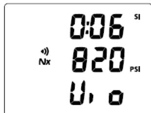
Рис. 88В Высокое парциальное давление кислорода на поверхности (менее 5 минут)
