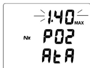
Рис. 30 Установка сигнала PO2
