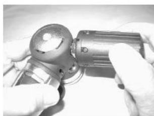
Рис. 55 Установка трансмиттера
