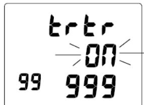
Рис. 37А Установка кода трансмиттера (ON/OFF)
