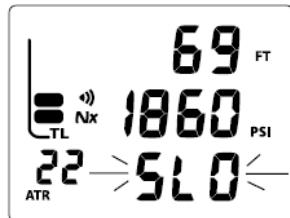
Рис. 65 Сигнал скорости всплытия
