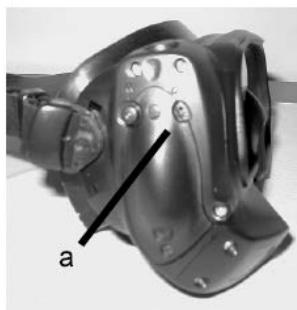
Рис. 114 Датчик глубины
