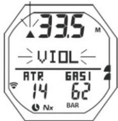
Рис. 96В Основной экран VGM (после отключения звукового сигнала)
