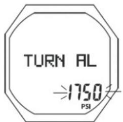
**Рис. 45 Установка включения давления**
