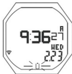
Рис. 5 Режим часов (сигнал разряженной батарейки)
