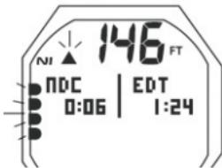
Рис. 141 Сигнал азотного накопления (TLBG)
