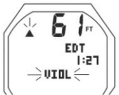
Рис. 142В Нарушение в свободном режиме (после звукового сигнала)
