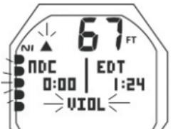
Рис. 142А Нарушение в свободном режиме (вход в декомпрессию, звуковой сигнал)
