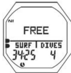
Рис. 124В Поверхностный свободный основной дисплей (34 мин после 4 погружений)
