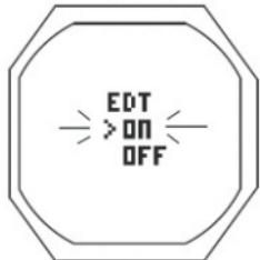
**Рис. 130** Дисплей установки сигнала прошедшего времени свободного погружения (EDT)
