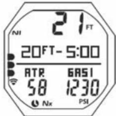
Рис. 83 Остановка безопасности основной экран
