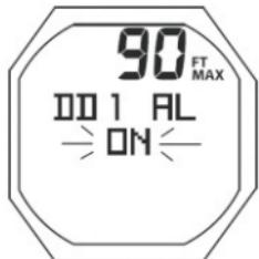
**Рис. 131** Дисплей установки сигнала 1 (DD 1)
