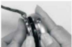
**Рис. 162** Снятие задней крышки
