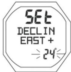
Рис. 153 Установка отклонения
