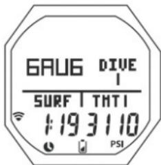
Рис. 115В Поверхностный измерительный режим (после первого погружения)
