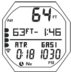
Рис. 80 Основной экран остановки безопасности
