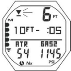
**Рис. 90** Незначительное нарушение (после звукового сигнала)
