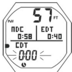
Рис. 138 Сигнал CDT (таймера) свободного погружения
