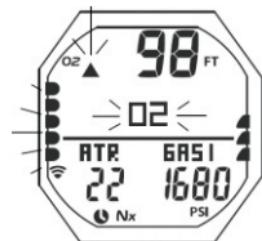
Рис. 104 Сигнал высокого PO2 (100%)
