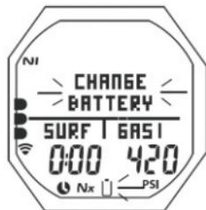
Рис. 4 Сигнал низкого заряда батарейки (после всплытия)
