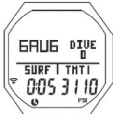
Рис. 115А Поверхностный измерительный режим (погружений еще не было)
