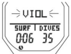
Рис. 143 Нарушение в свободном режиме (6 сек на поверхности)
