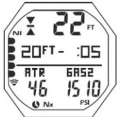
**Рис. 87** Основной экран декомпрессионного погружения
