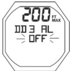
Рис. 133А Дисплей установки сигнала 3 (DD3) \*\*
