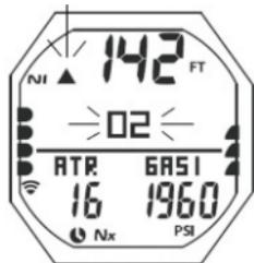
Рис. 104 Высокое PO2 (80%) Предупреждение (во время звукового сигнала)
