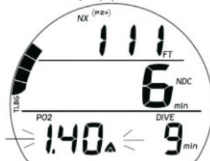
Рис. 57 сигнал PO2 (до тех пор, пока не станет меньше установленного)
