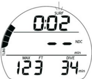
**Рис. 39** Основной дисплей бездекомпрессионного погружения (менее 10 мин на поверхности)
