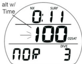
Рис. 61 основной поверхностный дисплей (более 10 мин после погружения)
