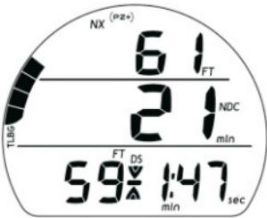
**Рис. 43** Основной экран глубины остановки безопасности
