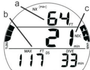
Рис. 3 основной дисплей бездекомпрессионного режима
