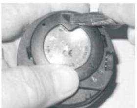
Рис. 69 Затягивание держателя
