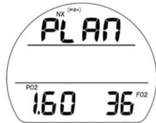
Рис. 23В Начальные установки Планировщика (FO2 установлен на нитрокс)
