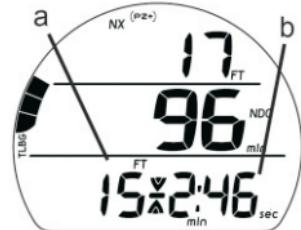
Рис. 4 основной дисплей остановки безопасности
