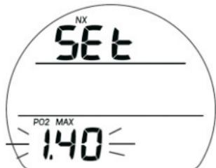
Рис. 27 Установка сигнала PO2
