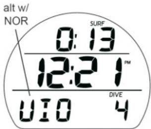
Рис. 55 Основной поверхностный режим VGM (поверхностный интервал более 10 мин)
