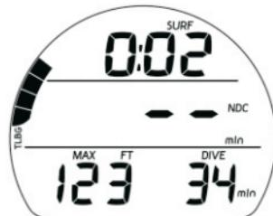
Рис. 14 Нормальный поверхностный режим (более 10 мин после 1 погружения)
