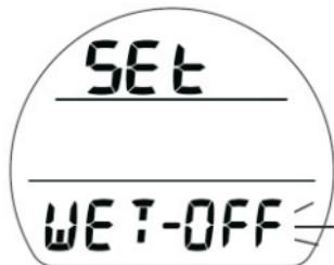
Рис. 28 Установка активации в воде
