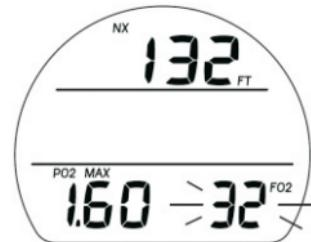
Рис. 25Б Установка FO2 (нитрокс)
