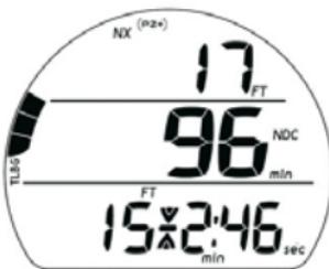
**Рис. 44** Основной экран времени остановки безопасности
