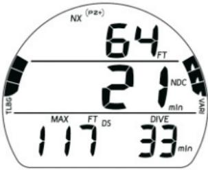
**Рис. 38** Основной дисплей бездекомпрессионного погружения
